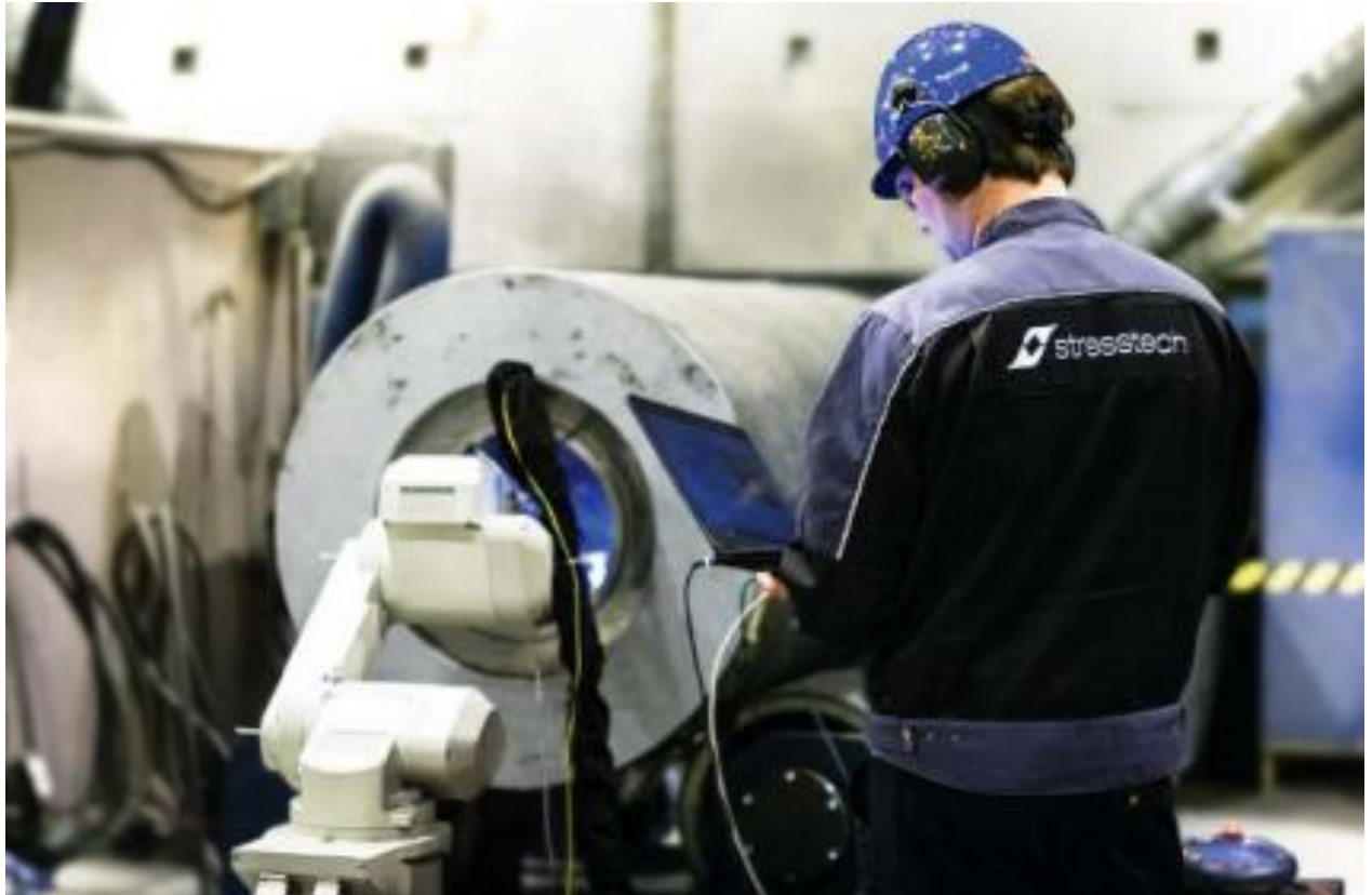
Рисунок 3.3 – Робот «Xstress» вимірює всередині циліндра.
