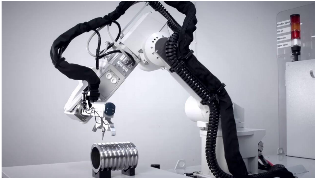
Рисунок 3.1 – Вимірювання залишкових напружень на деталі зі складною формою.
