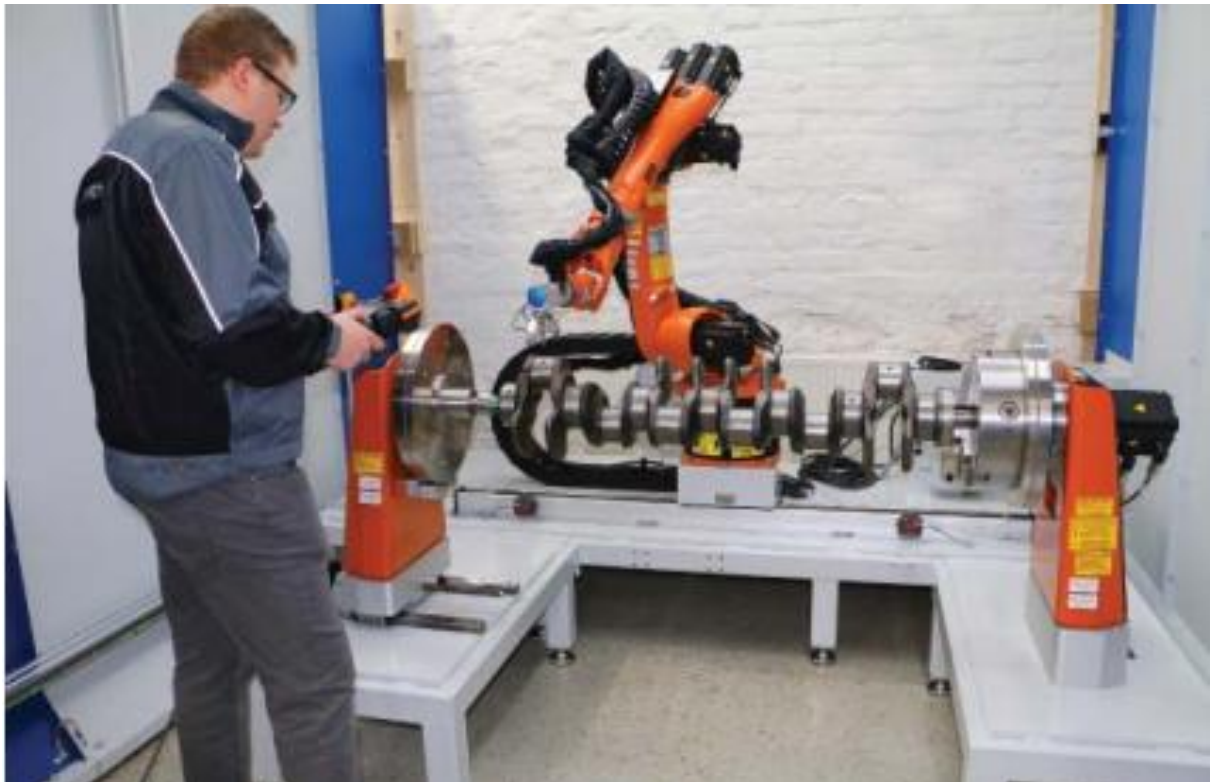
Рисунок 3.4 - Робот «Xstress» робить вимірювання на колінчастому валу.
