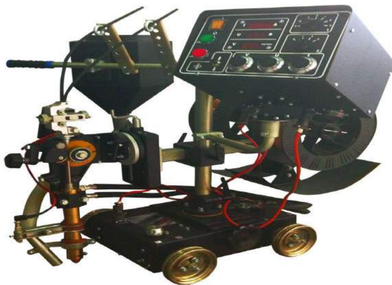
Рисунок 2.22 – Зварювальний автомат АДФ-1000
