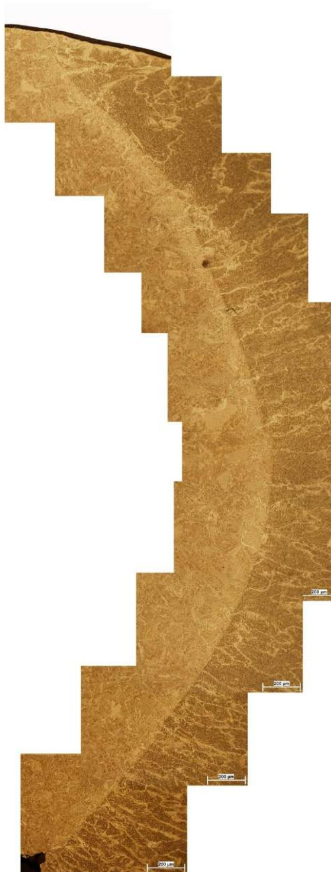
Рисунок 2.11 – Мікроструктура зони сплавлення зварного шву, який отримано за альтернативною технологією, x200
