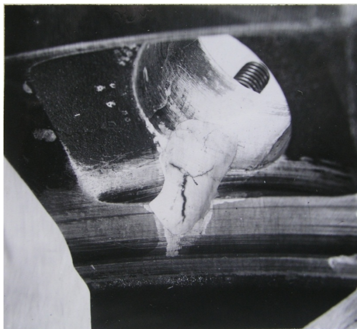
Рисунок 3.2 – руйнування деталі зі сплаву МЛ5 у вигляді тріщин
