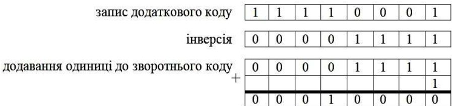
Рисунок 1.12 – Приклад зворотного перетворення додаткового коду до десятичного числа з урахуванням знаку
