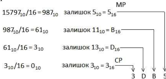
Рисунок 1.2 – Схема перетворення десятичного числа в шістнадцятеричний код
