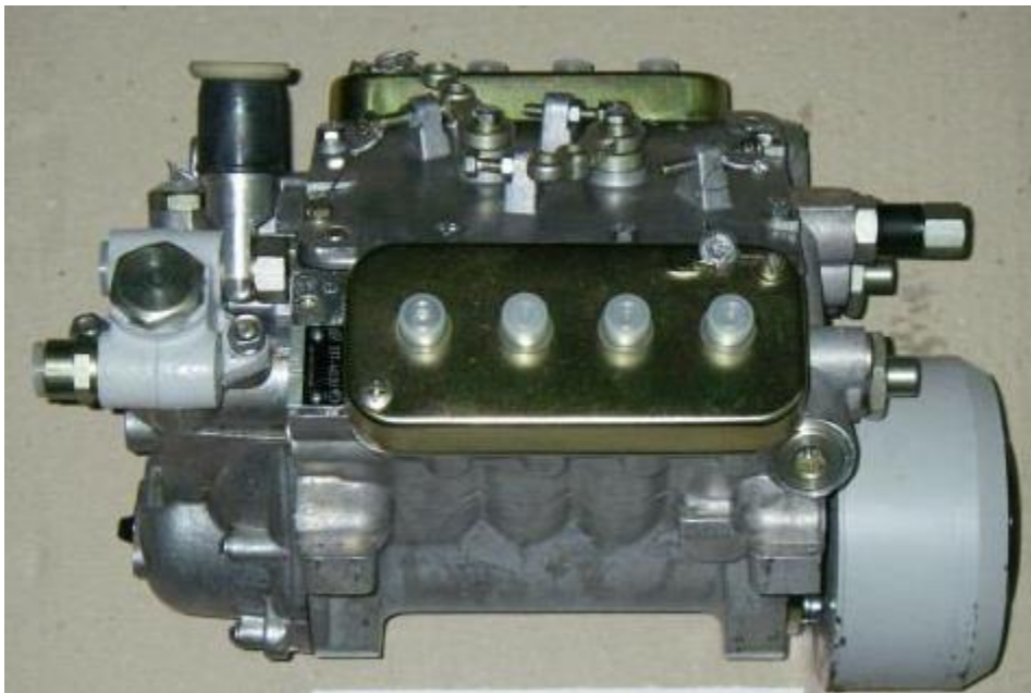
Рисунок 2.3 – Паливний насос високого тиску ЯЗДА 337.1111005-40.03
