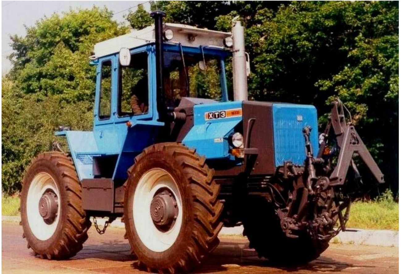
Рисунок 2.2 – Трактор ХТЗ-16331 з двигуном КамАЗ-740.02-18 [19]
