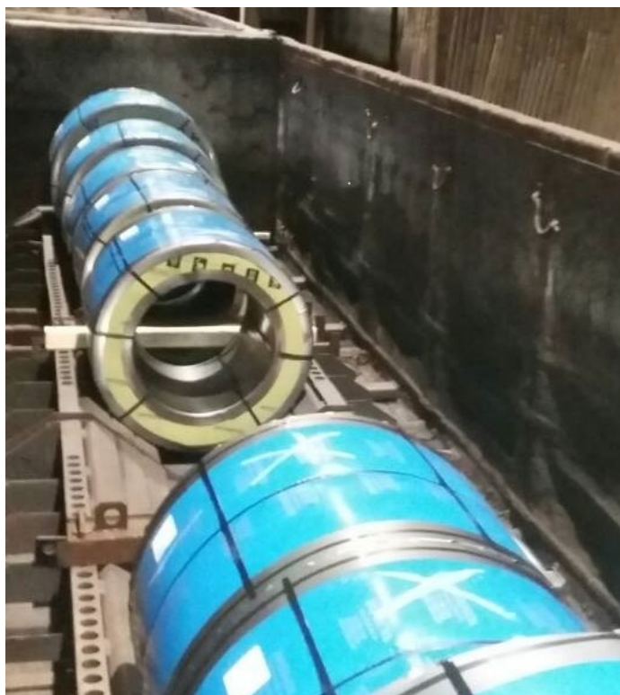
Рисунок 1.9 – Розміщення холоднокатаних рулонів у вагоні
