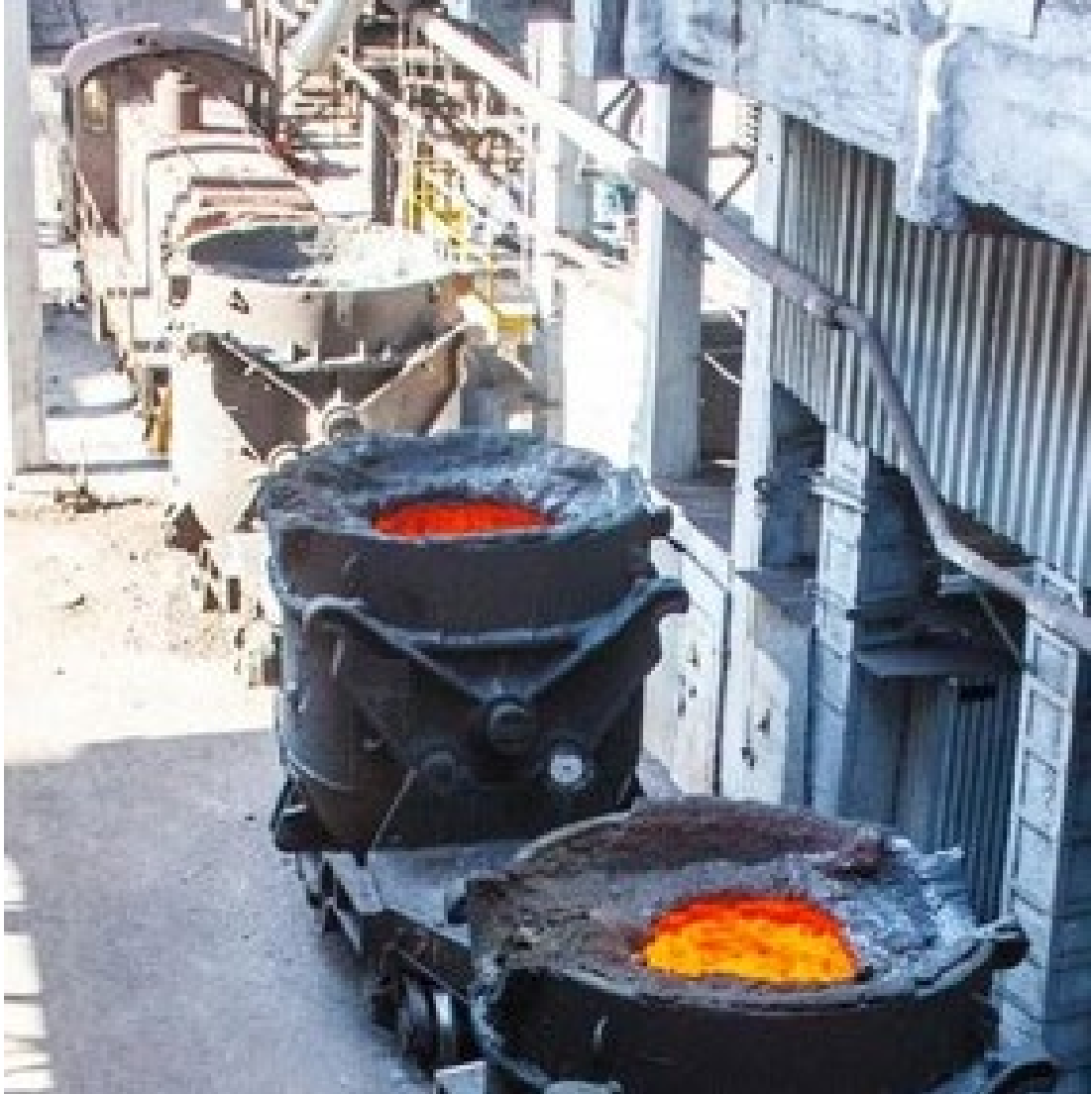
Рисунок 1.2 – Доставка чавуну до мартенівського цеху
