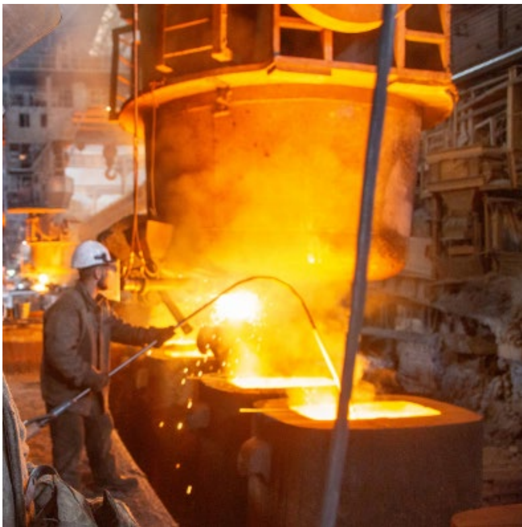
Рисунок 1.4 – Розлив сталі в мартенівському цеху
