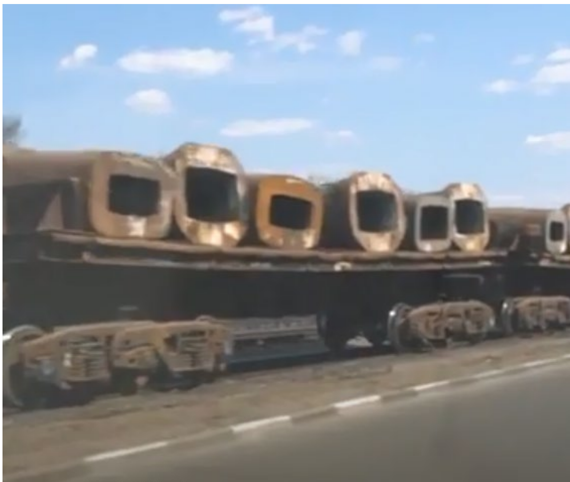
Рисунок 1.3 – Виливниці для розливу сталі
