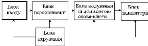
Рисунок 6.4 – Структурна схема пристрою "Шифратор"
