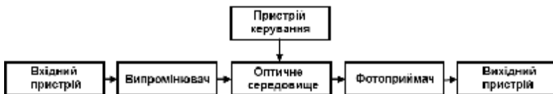
Рисунок 1.1 - Узагальнена структурна схема перетворювача
