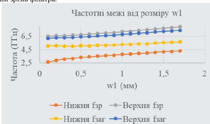
Рисунок 3 – Зміна частотних меж С-подібного мікросмужкового фільтра в залежності від розміру w_1
