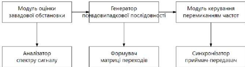
Рисунок 1 - Функціональна схема методу підвищення
