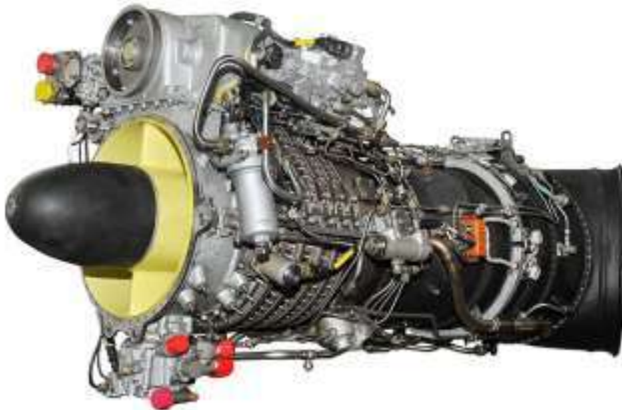
Рисунок 1.1 – Вертолітний авіадвигун виробництва “Мотор Січ” ТВ3-117ВМА-СБМ1В 1 серії [2]
