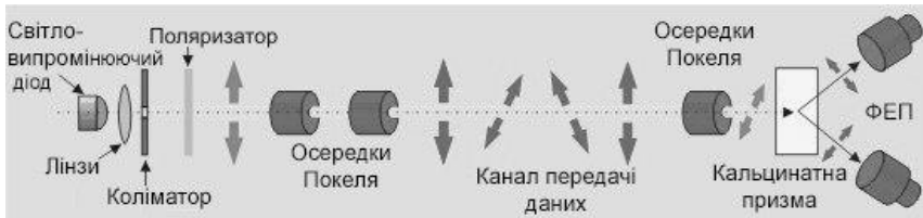
Рисунок 1 – Реалізація односпрямованого каналу з квантовим шифруванням
