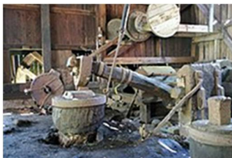
Рисунок 10.2 – Робота лобового молота
