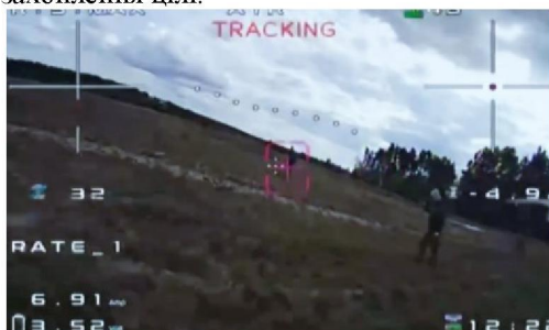
Рисунок 2 – Індикація захоплення та супроводження рухомої цілі внаслідок успішного машинного навчання
