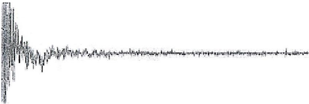
Рисунок 1.1 – Типовий графік загасання коливань в верстатах з напрямними ковзання (Вохвай) з накладними Торсайт
