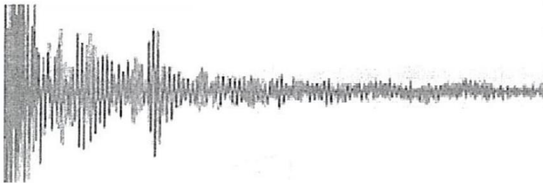
Рисунок 1.2 – Типовий графік вібрацій напрямних кочення .
