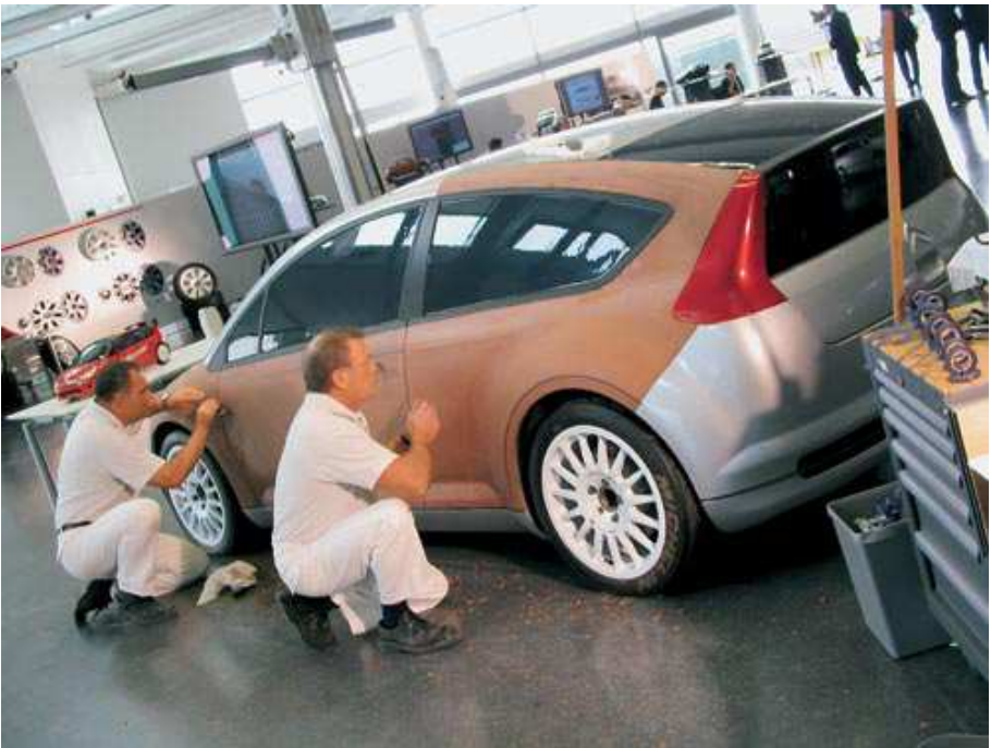
Рисунок 6.4 – Робота над макетом кузова автомобіля
