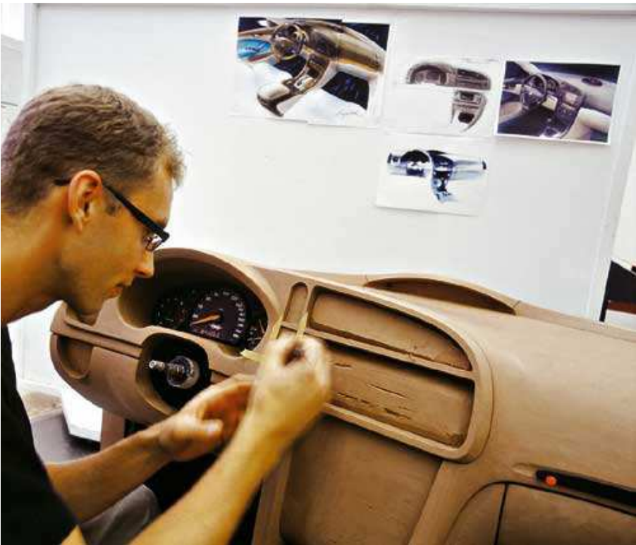
Рисунок 6.5 – Розробка макета панелі приладів
