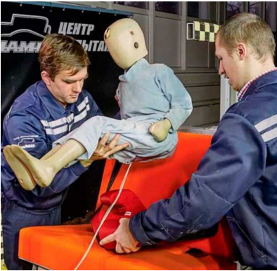
Рисунок 7.13 – Установка дитячого манекена на сидіння
