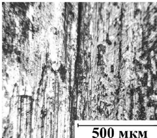
Рисунок 5.7 – Оптична мікрофотографія ліній тертя консолідованого зразку ММК системи Al-Ti-C (збільшення \times 250 ) [1].
