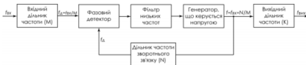
Рис. 1.9 – Структурна схема ФАПЧ в ПЛІС Cyclone III
