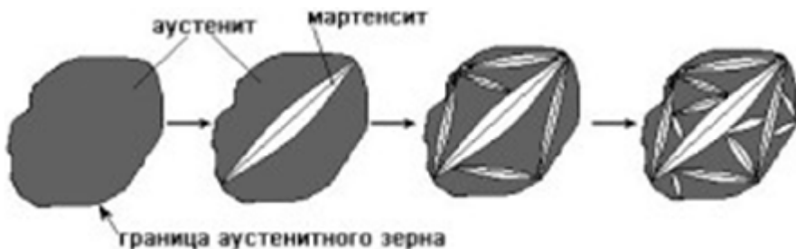
Рисунок 2.18 - Схема утворення мартенситу з аустеніту
