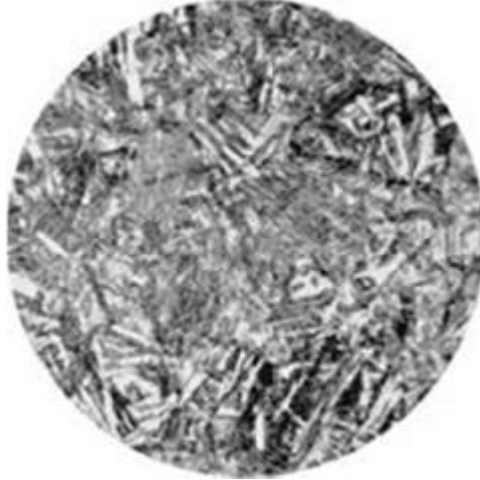
Рисунок 2.11 - Бейнітна структура сталі 60С2А (термообробка: 845° С протягом 10 хв, 310° С протягом 4200 с, охолодження в воді. Твердість 576 НV).
