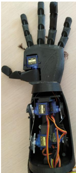
Рисунок 3.56 – Закріплення сервоприводів на механічній частині
