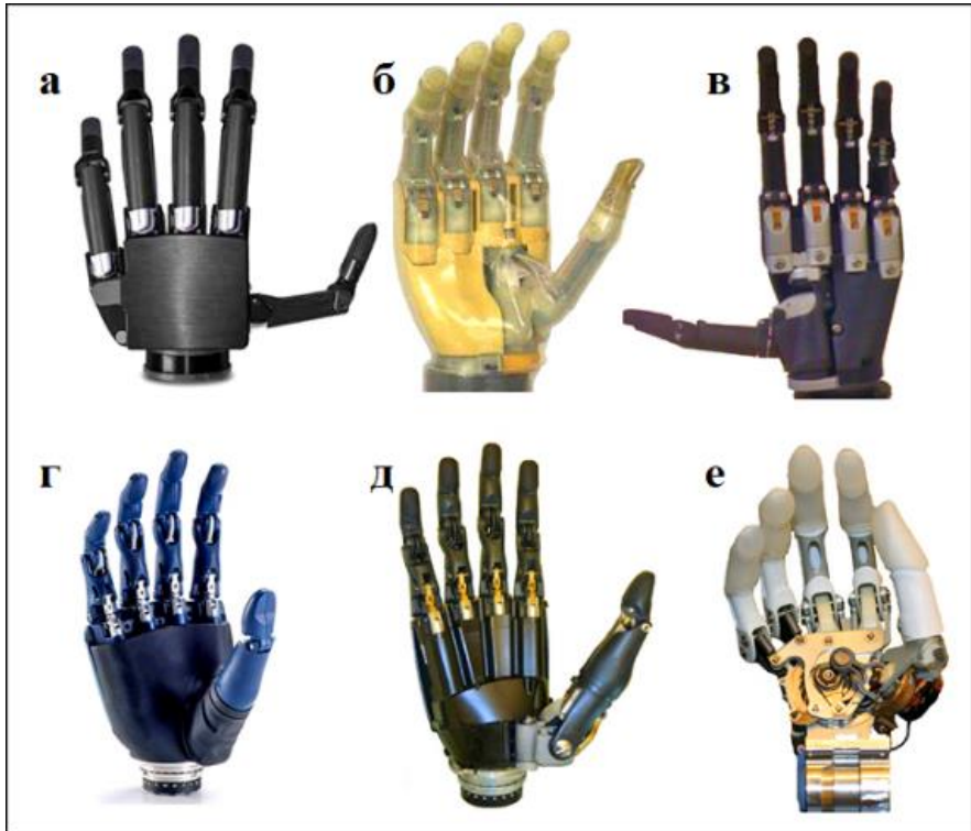
а – рука Vincent від Vincent Systems; б – рука iLimb від Touch Bionics; в – iLimb Pulse від Touch Bionics; г – рука Bebionic від RSL Steeper; д – рука Bebionic v2 від RSL Steeper; е – рука Michelangelo від Отто Бока
