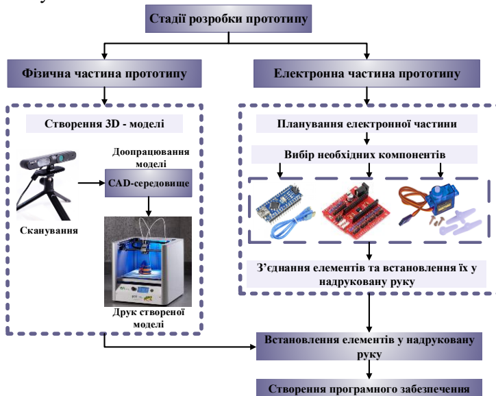
Рисунок 2.2 – Метод комплексного віртуального та фізичного прототипування
