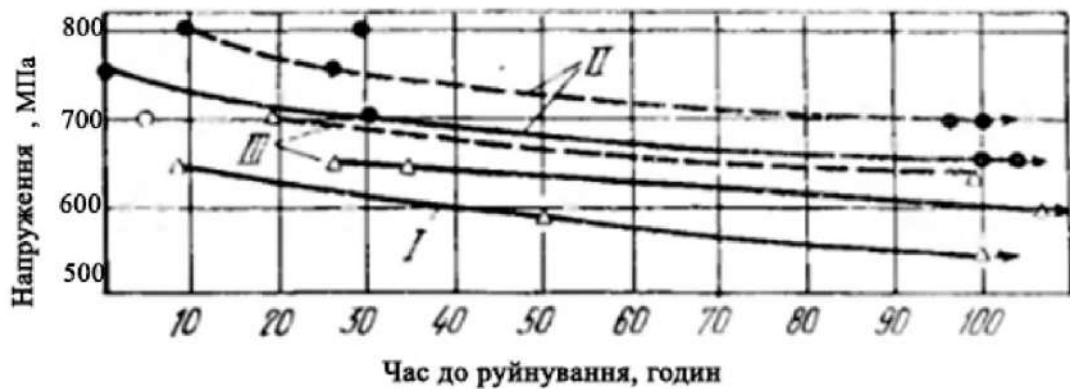
Рисунок 3.8 - Зміна тривалої міцності сплаву ВТЗ-1 залежно від типу структури й термічної обробки
