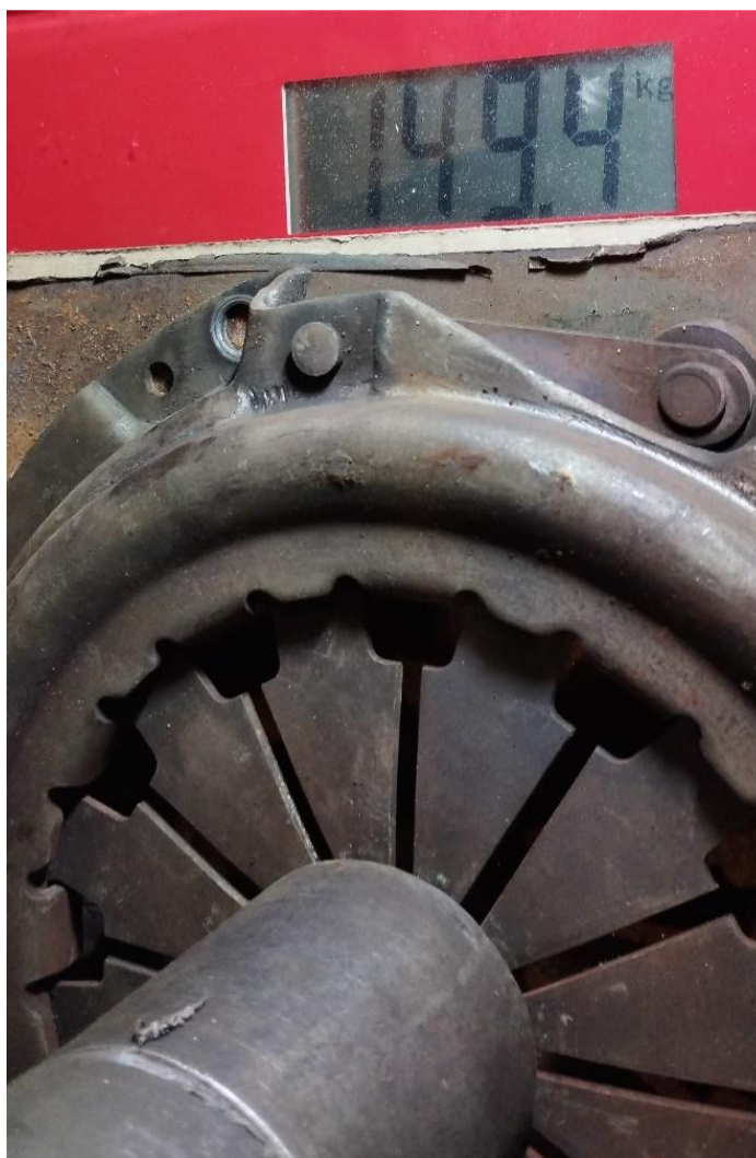
Рисунок 2.14 – Навантаження на пружини корзини зчеплення
