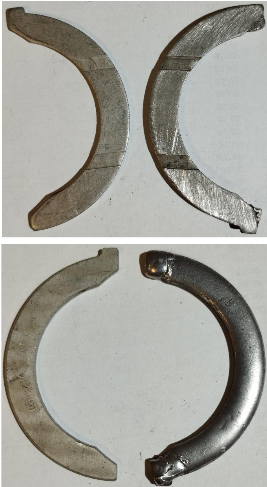
Рисунок 2.7 – Напівкільця двигуна Peugeot EB2 пізньої версії стандартне (зліва) та наплавлене бабітом (справа)
