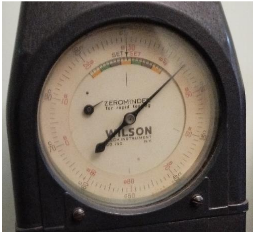
Рисунок 2.9 – Покази приладу вимірювання твердості
