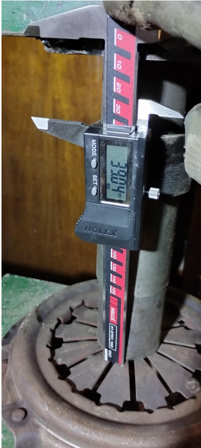
Рисунок 2.13 – Вимірювання відстані від краю пружин корзини зчеплення до привалочної площини корзини
