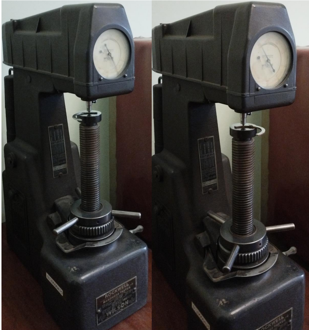
Рисунок 5.4 – Вимірювання твердості напівкільць двигунів МЕМЗ та ВАЗ
