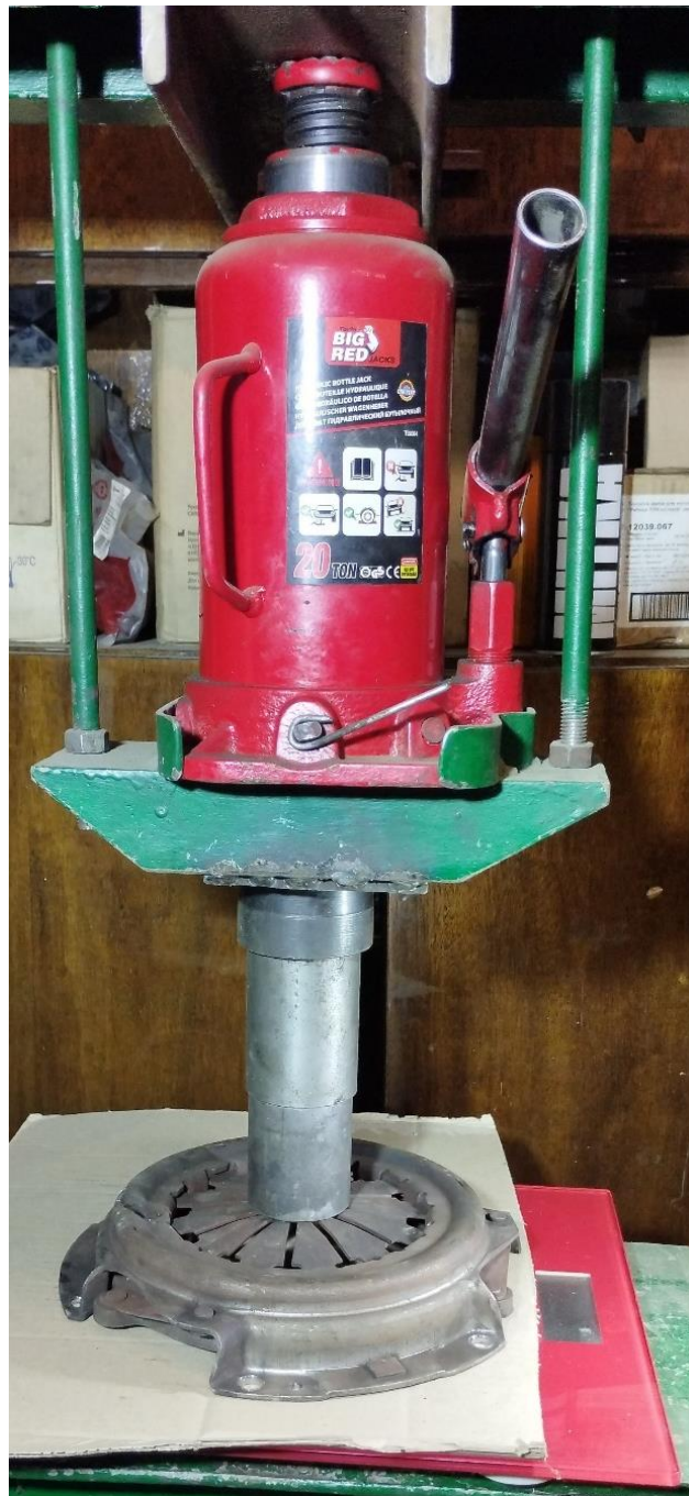
Рисунок 2.12 – Підвід упору преса до пружин корзини зчеплення
