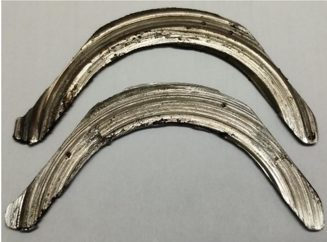
Рисунок 2.6 – Зношені напівкільця ранньої версії двигуна Peugeot EB2
