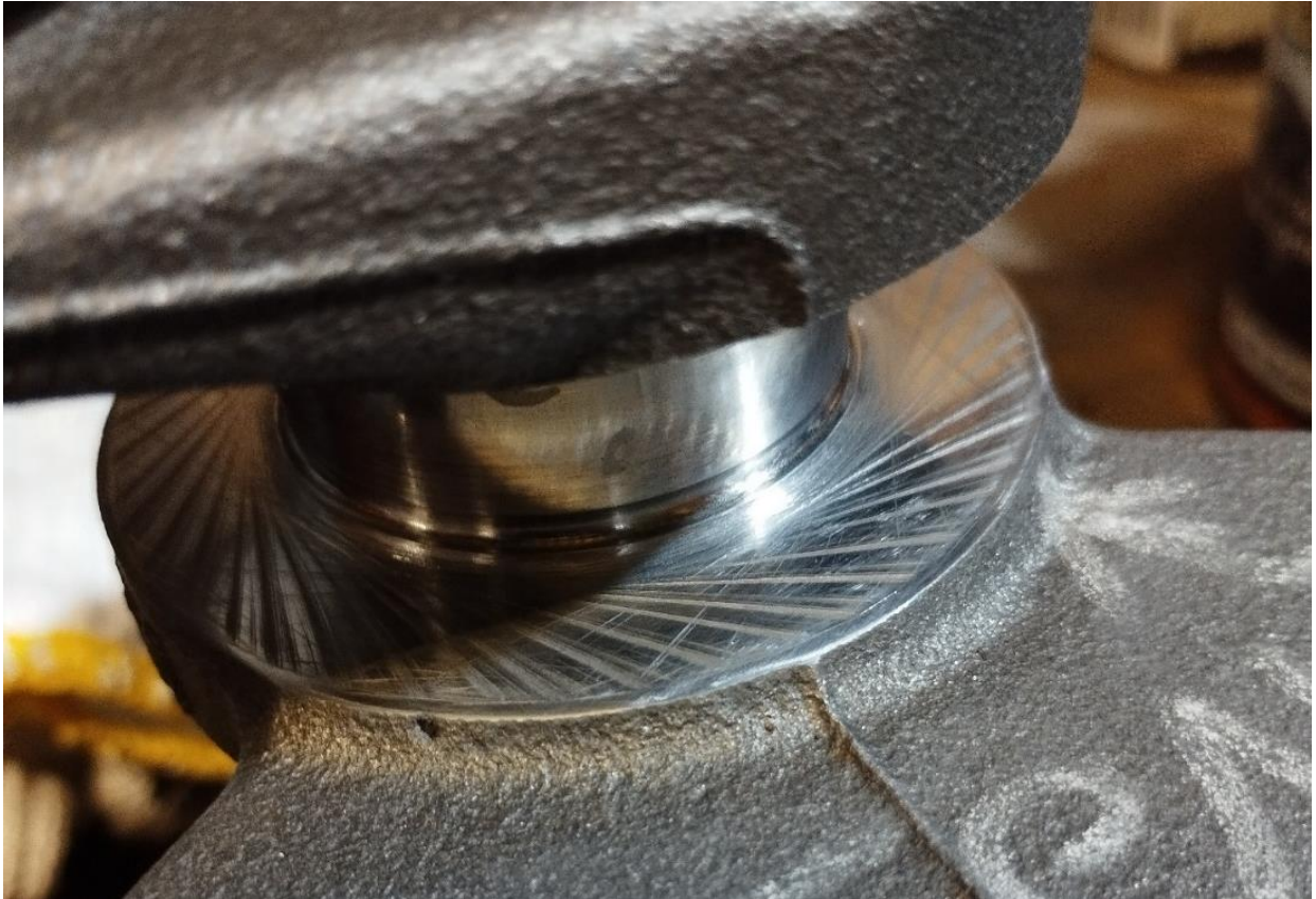
Рисунок 5.6 – Насічки на бічній поверхні другої шийки колінчастого валу
