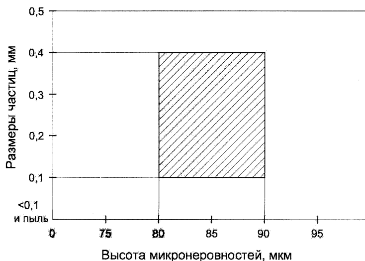
Рис. 3. Оптимальное соотношение размеров распыляемых частиц и микрорельефа, которое обеспечивает наибольшую прочность сцепления плазменного покрытия
