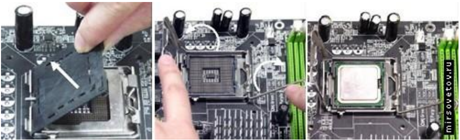
Рисунок 2.1 – Встановлення процесора в материнську плату
