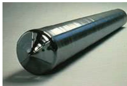
Рисунок 1.2 - Монокристалічний злиток кремнію, який був отриманий за методом Чохральського
