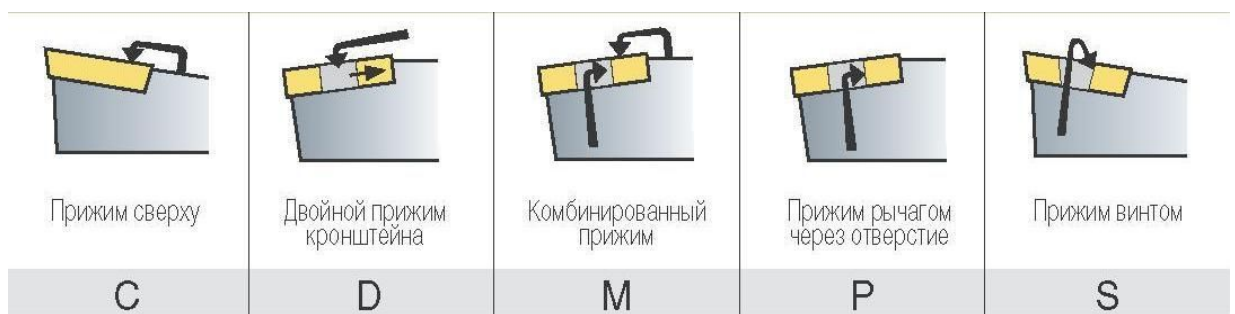
Рисунок 5.2 – Основні типи (схеми) кріплень пластинок в корпусі інструменту
