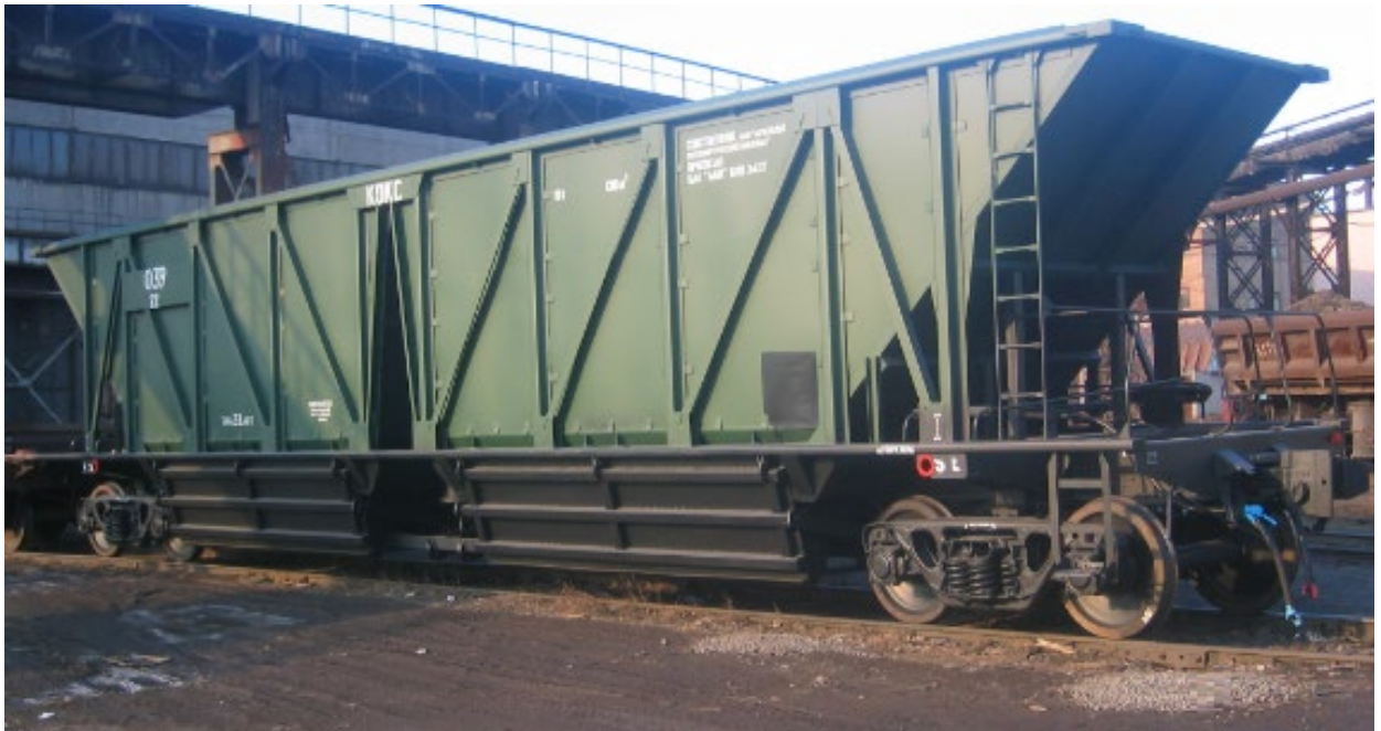
Рисунок 1.8 – Коксовоз виробництва українського підприємства Дніпровагонмаш
