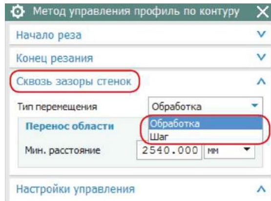
Рисунок 6.10 - Параметр «Крізь проміжки стінок» відновлює прохід там, де стінки немає
