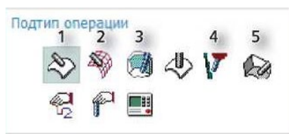
Рисунок 5.1 - розташування команд операцій 5 - осьової безперервної обробки
