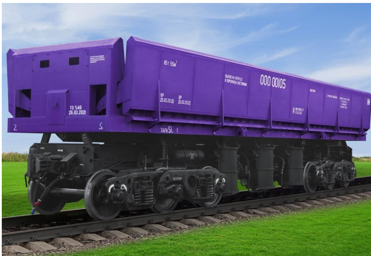
Рисунок 2.1 – Загальний вигляд вагону-думпкару
