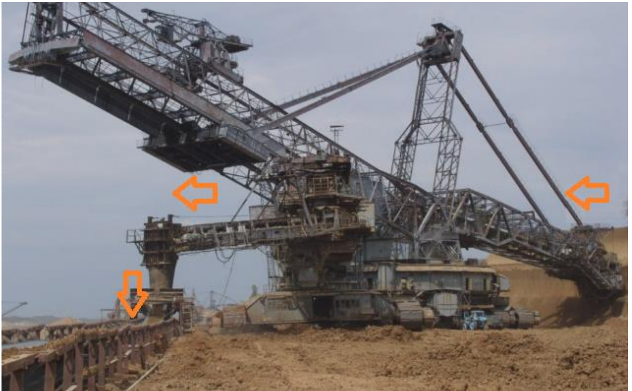
Рисунок 1.1 – Схема транспортування марганцевої руди роторним екскаватором
