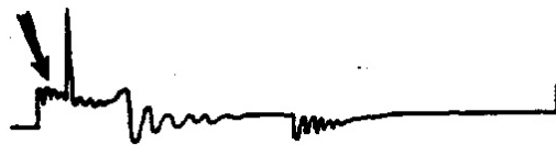
Рисунок 1.8 – Несправний конденсатор або поганий контакт між конденсатором і переривником
