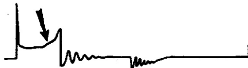
Рисунок 1.15 – Внутрішній опір (лінія горіння іскри нахилена вгору)
