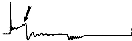
Рисунок 1.13 – Іскра включає внутрішній опір (лінія горіння іскри спрямована вгору)
