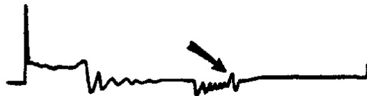
Рисунок 1.4 – Неправильний сигнал сигнального механізму в первинному ланцюзі системи запалювання
