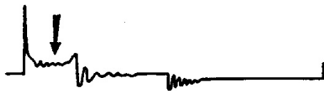
Рисунок 1.14 – Паливна суміш багата (лінія горіння іскри нижче й більш довга ніж нормальна)
