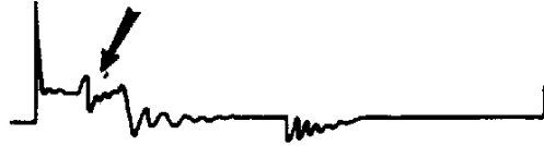
Рисунок 1.17 – Несправність кришки розподільника запалювання
