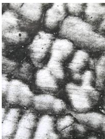
Рисунок 5.15 – Мікроструктура пера (а, б, в) та замка (г, д, е) робочої лопатки зі сплаву ЖС26-ВІ після ГП + 850 °С, 24 год.
