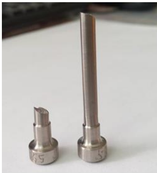
Рисунок 4.22 – Зовнішній вигляд зразка зі сплаву ЖС32-ВІ (плавка №1) після випробувань.
