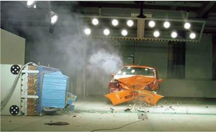
Рисунок 4.6 – Випробування автомобіля на фронтальний удар
