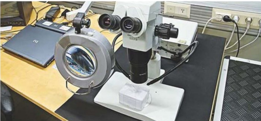
Рисунок 4.8 – Обладнання фірми Тікка для контролю протектору шин
