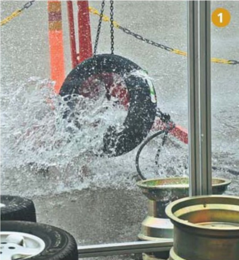
Рисунок 4.11 – Випробування шин водою
