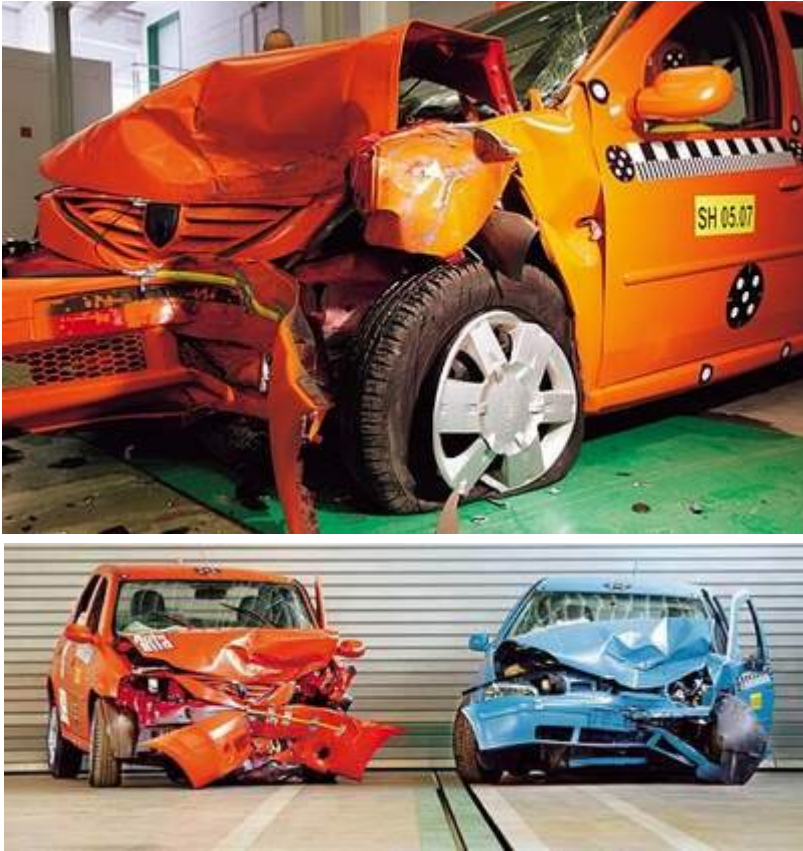
Рисунок 4.7 – Кузова автомобілів після проведення випробувань на фронтальний удар
