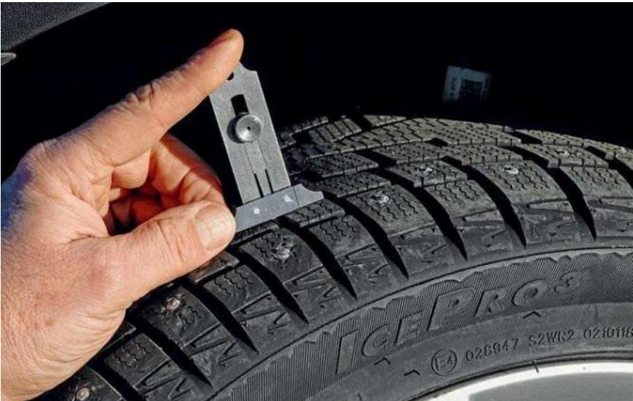
Рисунок 4.10 – Пристрій для виміру глибини протектора шини
