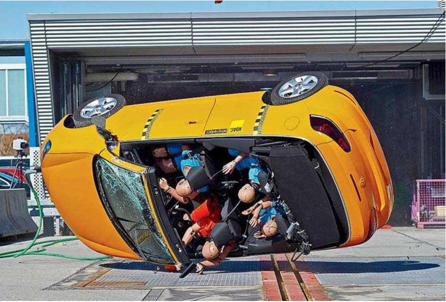
Рисунок 4.5 – Випробовування кабіюлета на перекидання
