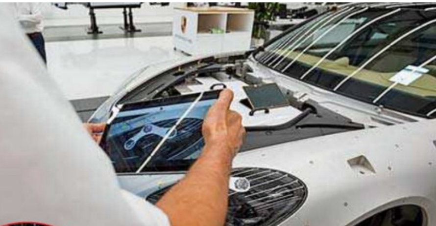
Рисунок 4.3 – Використання технологій "доповненої реальності": планшет використовується для порівняння форми випробуваного кузова з 3D-моделлю
