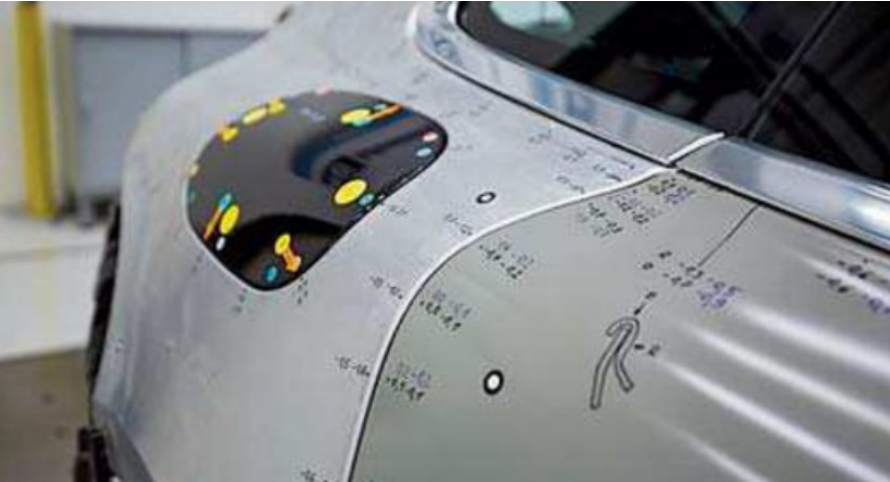
Рисунок 4.2 – Маркери нанесені на кузов для оцінки якості поверхні під навантаженням
