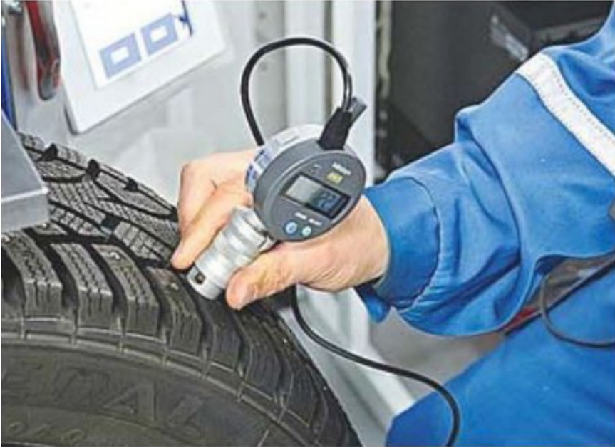
Рисунок 4.9 – Забір глибини протектора шини
