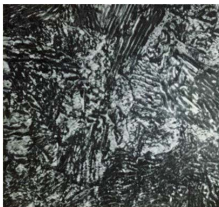
Рисунок 4.3 – Мікроструктура сталі Р6М5 після оптимального режиму термічної обробки[5]
