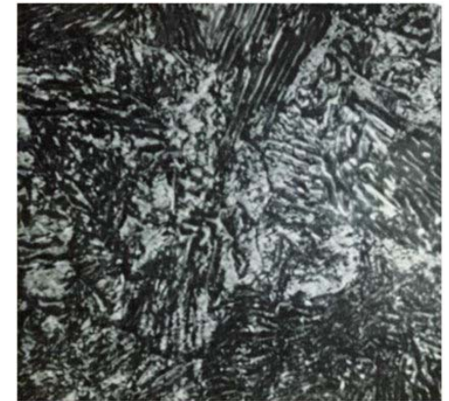
Рисунок Б2 – Мікроструктура сталі Р6М5 після оптимального режиму термічної обробки
