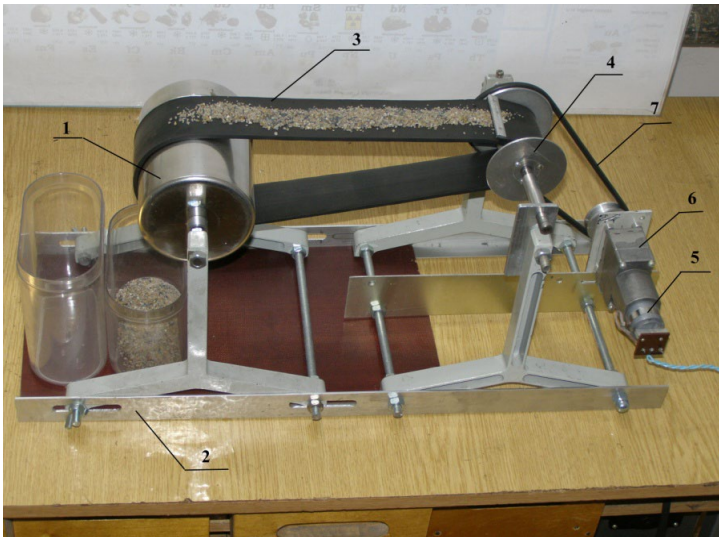
1 – відомий барабан; 2 – основа сепаратора; 3 – гумова транспортерна стрічка; 4 – ведучий барабан; 5 – електродвигун; 6 – редуктор; 7 – ремінна передача Рисунок 2.1.2 – Лабораторний магнітний сепаратор
