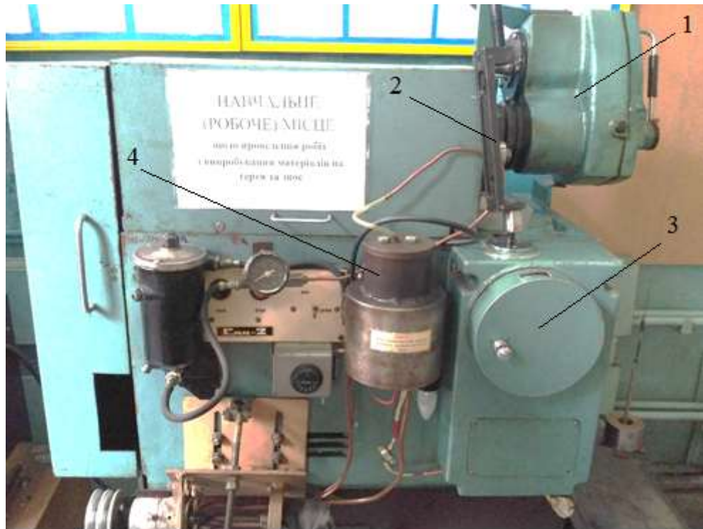
1 – каретка навантаження; 2 – скоба гвинта; 3 – шкала навантажувального пристрою; 4 – насосна установка для подачі мастила;
