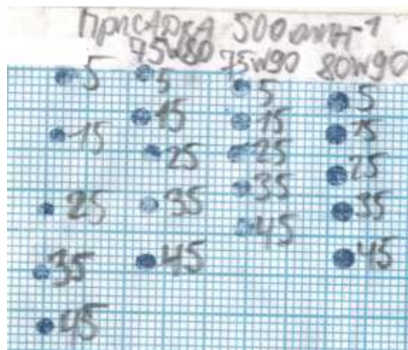
Рисунок 5.4 - Визначення відбитків, площин контакту за зносом поверхні кульки при різних навантаженнях
