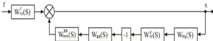
Рисунок 1.7 – Структурна схема САР по збурюючому фактору
