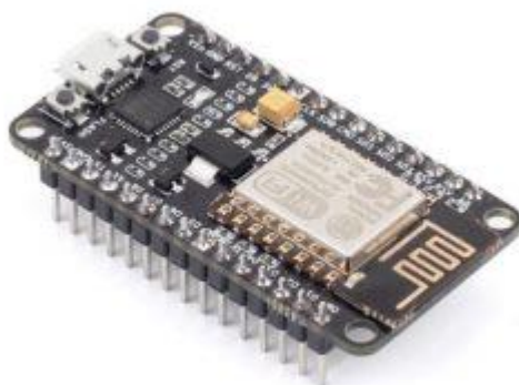
Рисунок 3.6 – NodeMCU на базі ESP8266 [21]
