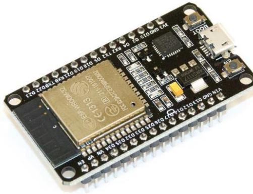
Рисунок 3.9 – Модуль ESP32 NodeMCU [23]
