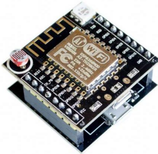
Рисунок 3.8 – Witty Cloud на базі ESP8266 [22]
