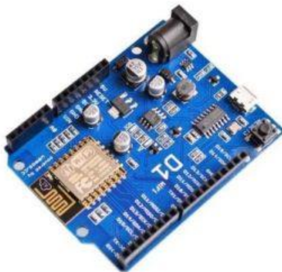
Рисунок 3.7 – WeMos на базі ESP8266 [21]
