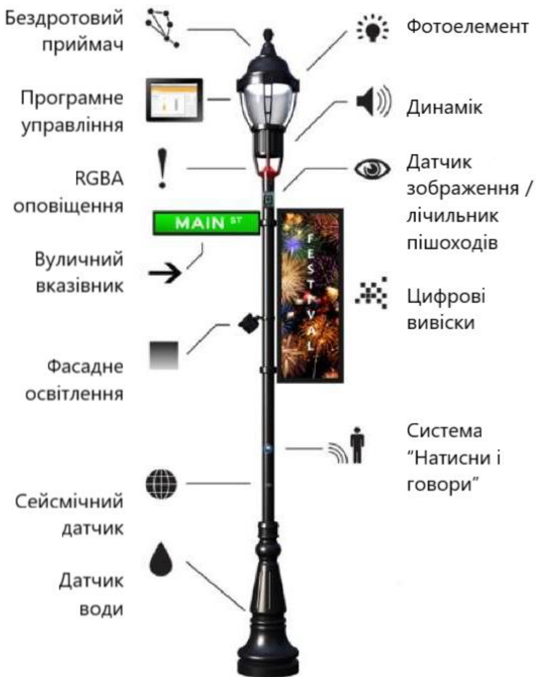
Рисунок 3.2 – «Розумна» опора системи освітлення [20]
