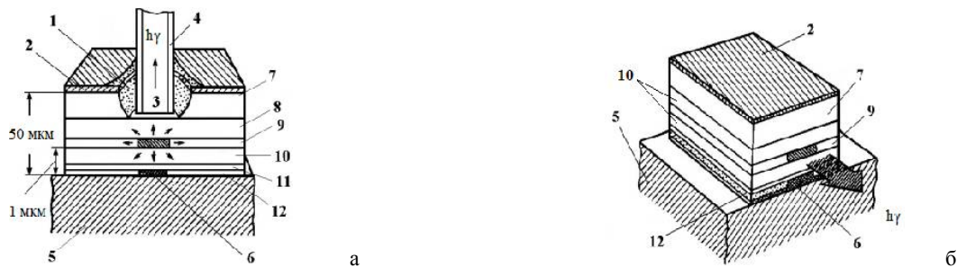
Рис.2 Відомі ескізи конструкцій інтегральних СД на основі НПС: поверхневий (а), торцевий (б) вихід випромінювання (ПВВ, ТВВ). Різні шари НПС СД позначені цифрами для їх функціональної ідентифікації (при створенні технологічної карти процесу та їх виготовлення)
