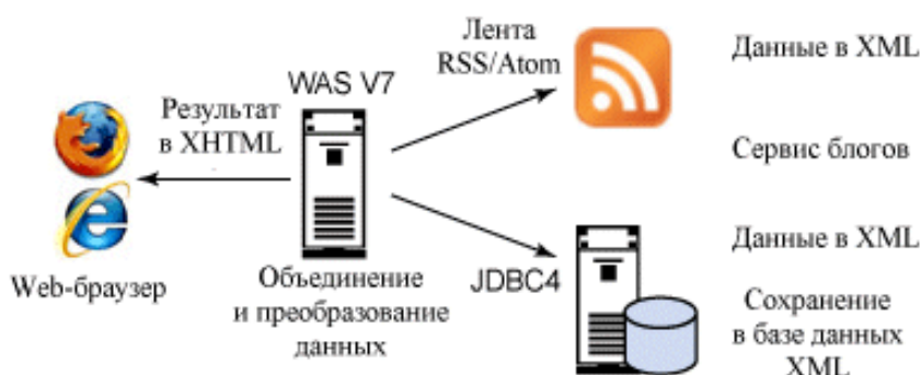
Малюнок 1. Схема перевірки коментарів у блозі, інтегрованому з базою даних
