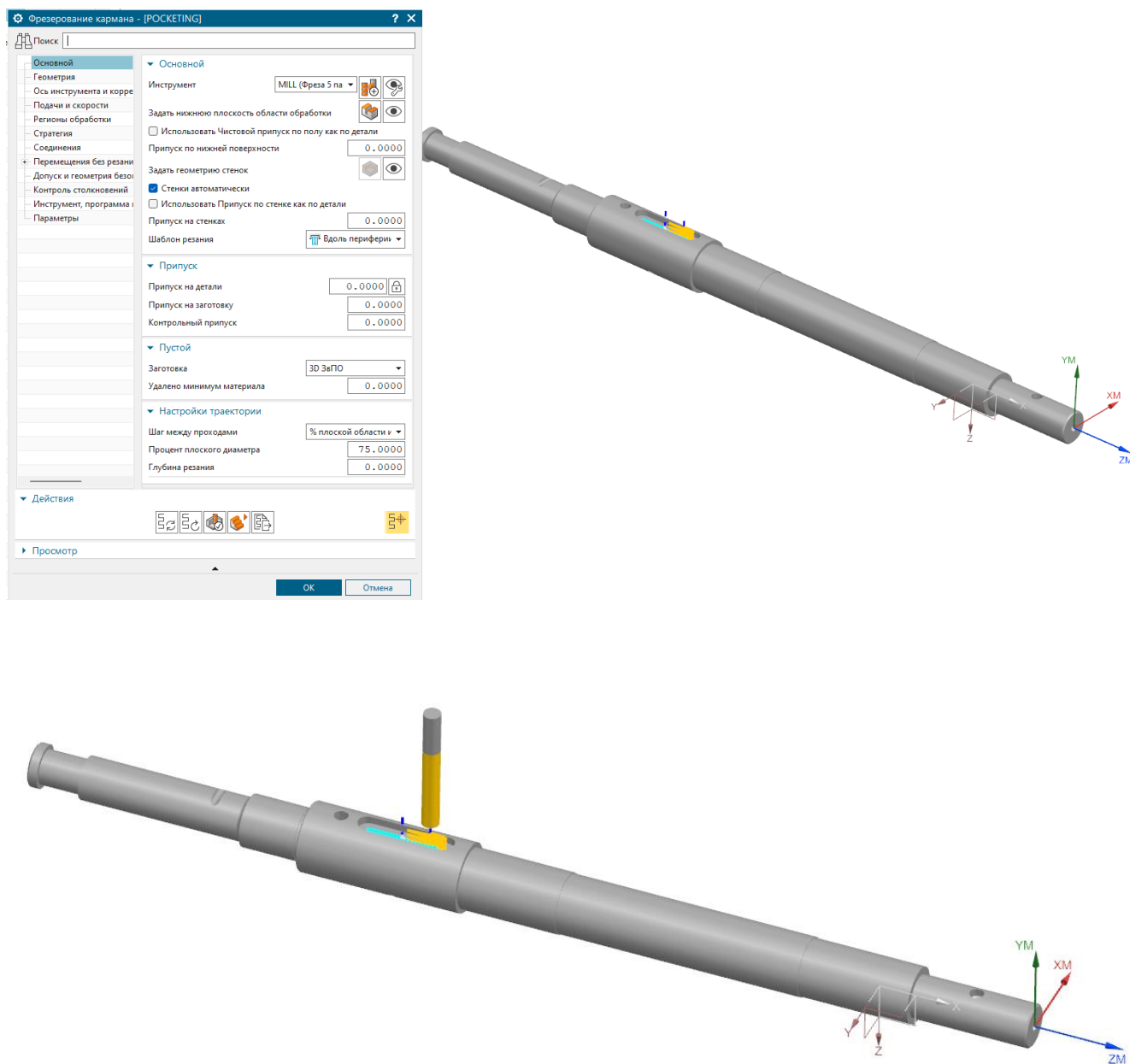
Рисунок 1.17 – Створення операції фрезерування
