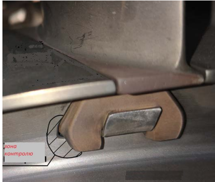
Рисунок 1 – Зона контролю міжпазового виступу диску компресора авіаційного двигуна.
