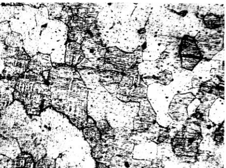
Рисунок 4.27 - Мікроструктура дротів зі сталі 03X22Ю5ФБч (x200):
