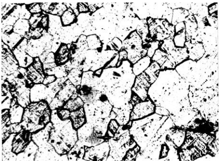
Рисунок 4.27 - Мікроструктура дротів зі сталі 03X22Ю5ФБч (x200):
