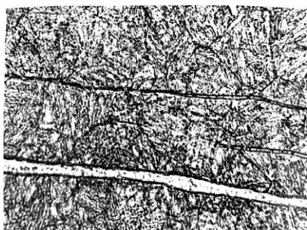
Рисунок 4.1 - Мікроструктура сталі 18X15N3M–Ш у центрі сортового прокату.
