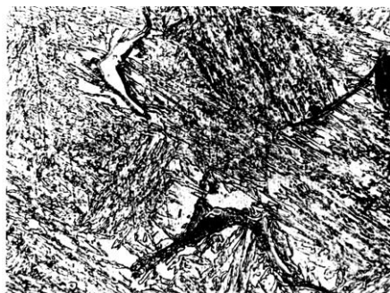
Рисунок 4.6 - Мікроструктура сталі 18X15H3M–Ш у литому стані (x800).
