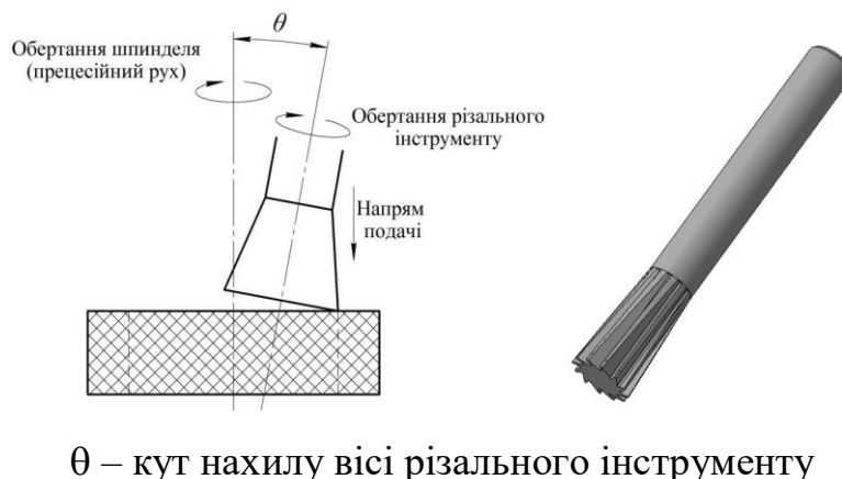
Рисунок 1.7 – Схема методу прецесійного свердління та 3D модель різального інструменту [13]
