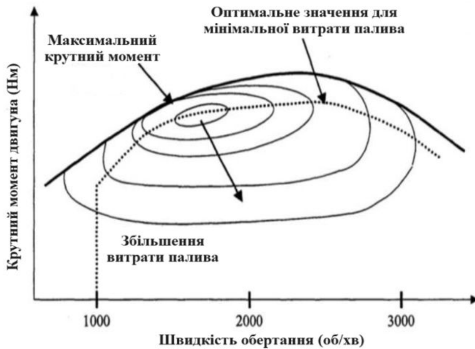
Рисунок 4 – Характеристики дизельного двигуна, що пов'язані з двохолюсним генератором
