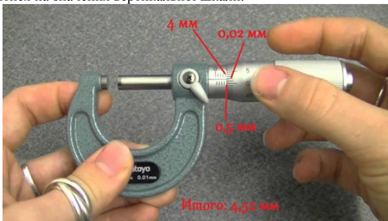
Рисунок 2.3 – Приклад обчислення показань мікрометра
