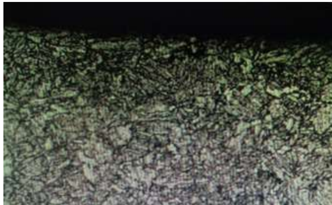
Рисунок 3.3 - Мікроструктура в серцевині зубів, x200
