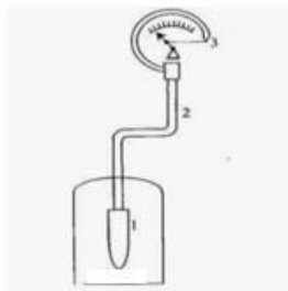
1 – балон; 2 – вимірювальна трубка; 3 – манометр
