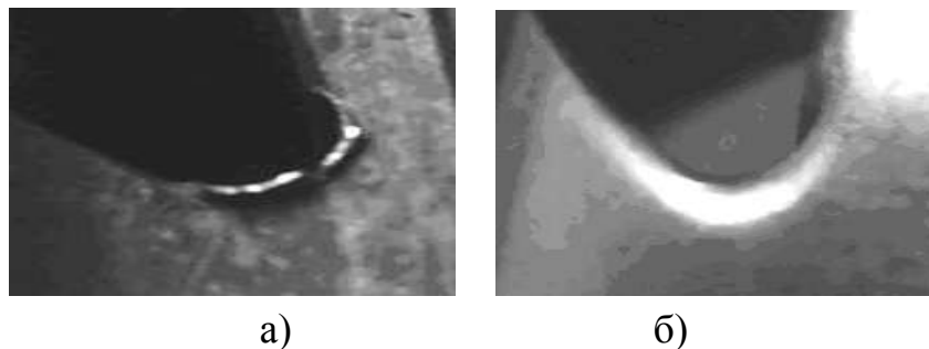
Рисунок 6.5 - Приклад обробленої поверхні западини зубів: а) після зубофрезерування; б) після слюсарного оброблення ПАЩ
