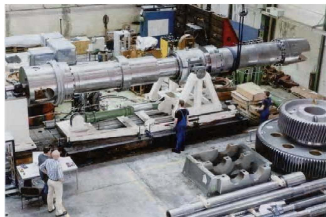
Рис. 6. Шпиндель конструкции фирмы SMS-SIEMAG, позволяющий осевой сдвиг рабочих валков
