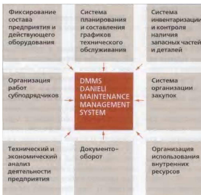
Рис. 9. Система технического обслуживания оборудования фирмы Danieli
