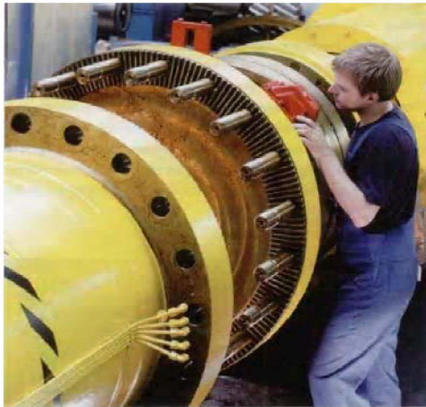
Рис. 7. Соединение головки шпинделя с валом конструкции фирмы SMS-SIEMAG
