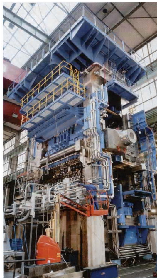
Рис. 5. Прокатная клетка 5000 на стенде
