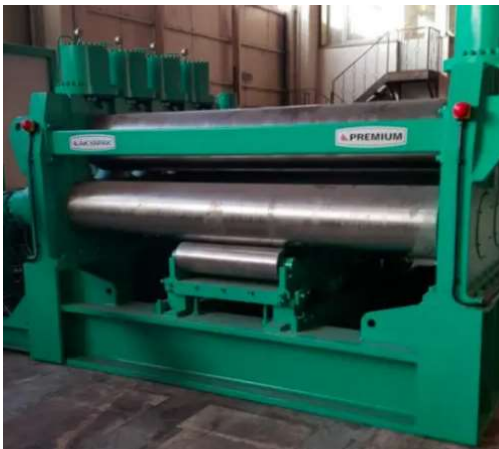
Рисунок 3.1 – Вальці листоправильні Bendmak BPSM 20/25
