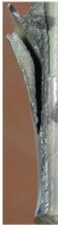
Вид тріщини, що розкрилась з боку корита
