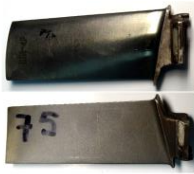
Вид лопатки з тріщиною
