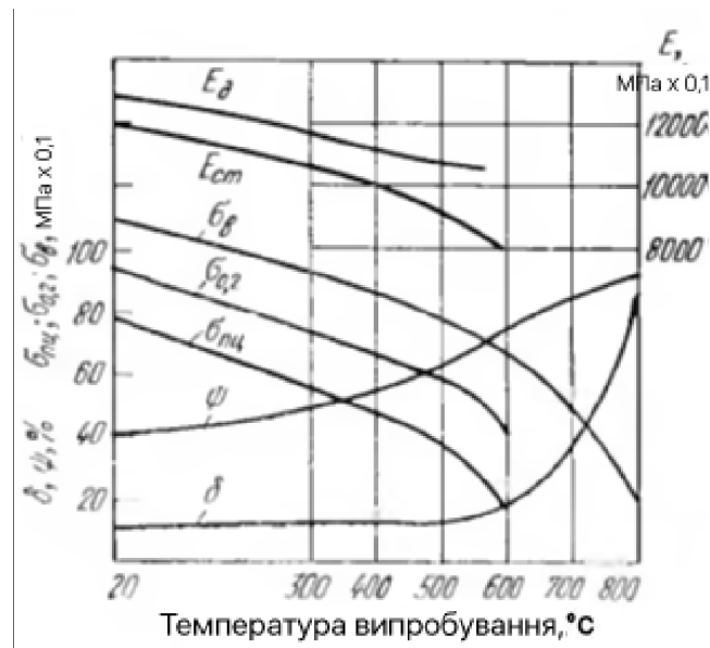
Рисунок 3.13 – Механічні властивості ВТ8 в залежності від температури випробування.
