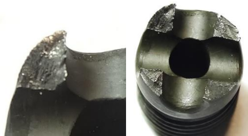
Рисунок 3.1 - Макробудова зламу за місцем руйнування штуцера.
