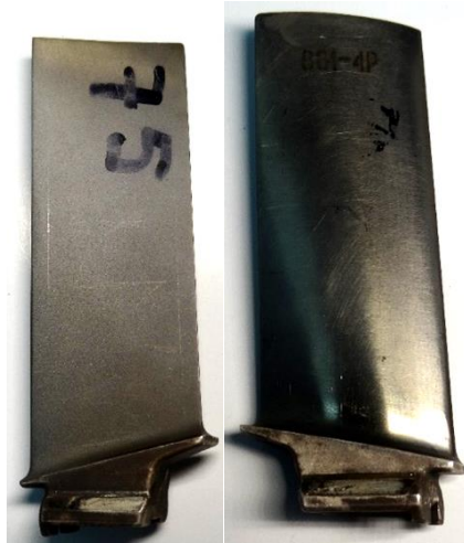
Рисунок 2.3 – Вид лопатки з тріщиною.
