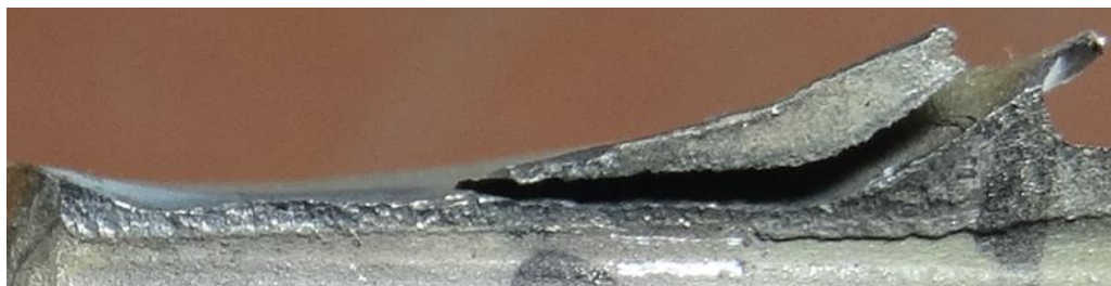
Рисунок 3.3 – Вид тріщини, що розкрилась з боку корита.
