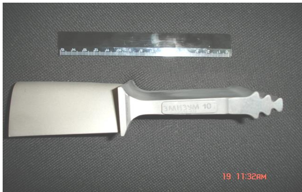
Рисунок 4.2 - Робоча лопатка ТВТ зі сплаву ЗМІ-3У з 4% танталу з підвищеним ресурсом експлуатації газоперекачувальних агрегатів ГТК-10І
